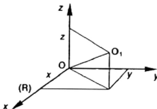
Figure.2. Système de coordonnées cartésiennes.
