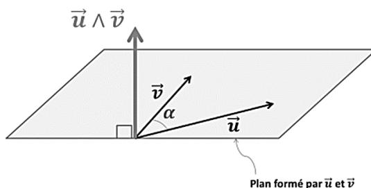
Figure.9. Produit vectoriel de deux vecteurs coplanaires,  $\vec{u}$  et  $\vec{v}$ .
