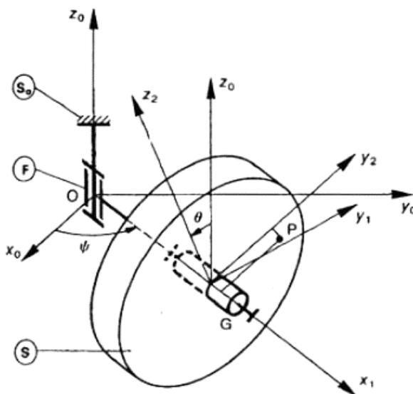
Figure.7. Schéma cinématique spatial de l'équilibreuse de roue.
