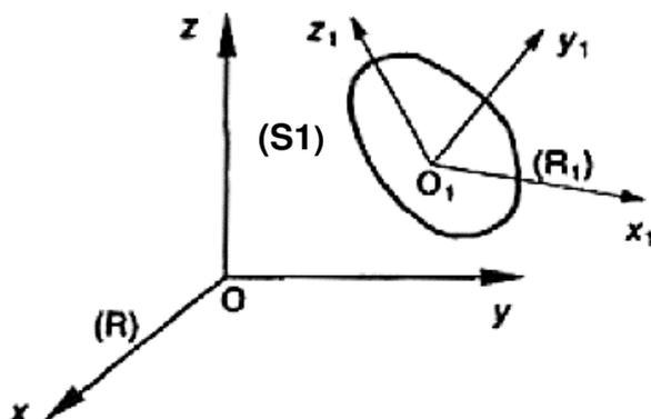
Figure.1. Configuration générale pour paramétrer un solide (S1).
